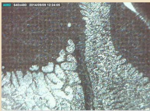
Příklady odlupující se laminace
